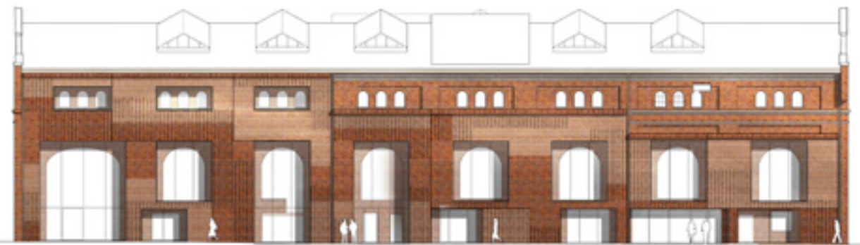
Elévation ouest de Gjuteriet, photo et dessin. En haut: état actuel; un collage vivant de couches historiques. En bas: couche de brique ajoutée et écran protégeant du gel.
